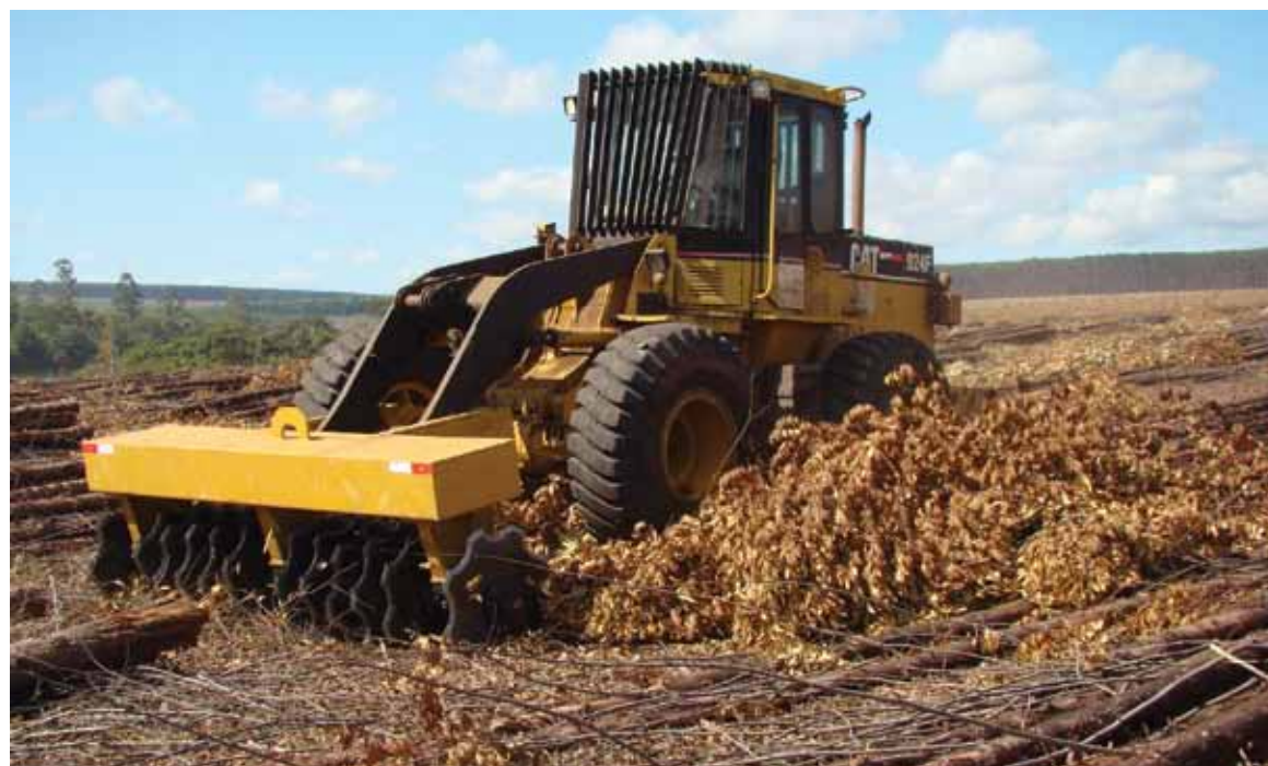
Máquina de média potência com desgalhador com discos cortados.
